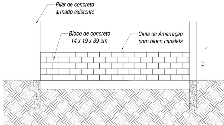
DETALHAMENTO MURO H=1,10m
