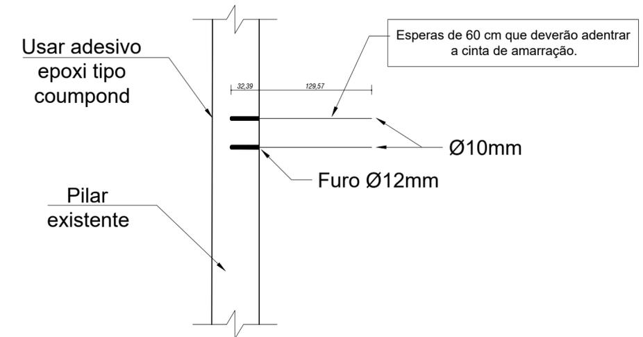
DETALHAMENTO DE ENGASTAMENTO DA ARMADURA NOS PILARES EXISTENTES
